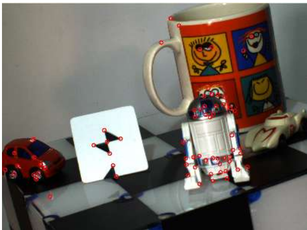
Figura 1. Detección de esquinas con Harris.
