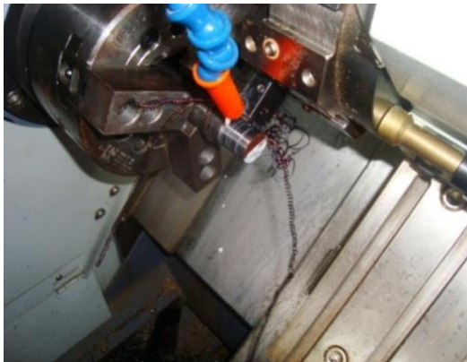
Figura-4. Operación de cilindrado del acero AISI 4140
