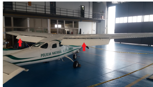
Figura 6. Flaps del avión Cessna 206.
