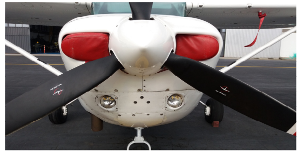
Figura 5. Luces de aterrizaje y carreteo.
