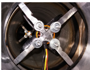
Figura 1. Armazón ensamblado en el banco de ensayos.
