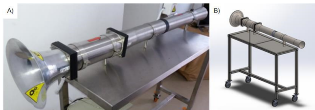
A) Fotografía real del banco de ensayos y B) Modelo en SolidWorks del banco de ensayos de ventiladores.
