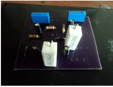
Figura. 15. Tarjeta madre con componentes instalados
