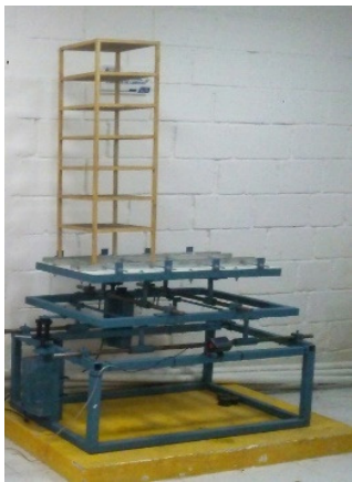
Figura. 1. Estructura simuladora de sismos
