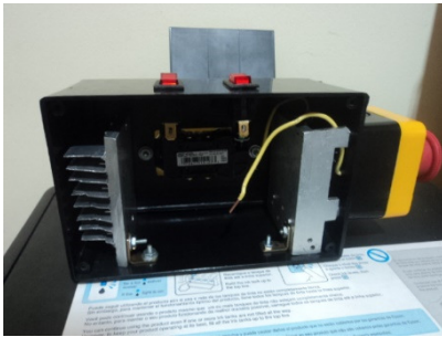
Figura. 16. Caja protectora del circuito
