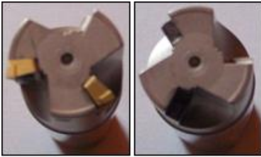
Figura 1. Geometría de la herramienta de corte.
