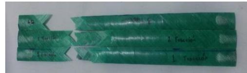
Figura 8. Probetas sometidas a carga estática.
