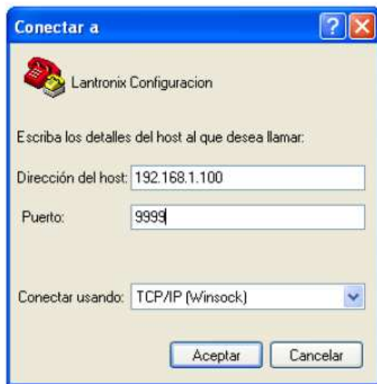
Figura 6. Parámetros básicos de configuración de Hyperterminal para la conexión Telnet al Wiport
