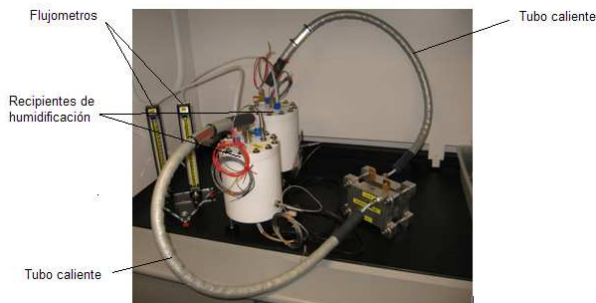
Figura 17. Montaje de la celda de combustible
