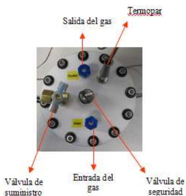
Figura 13. Vista superior del recipiente a presión para la humidificación de gases
