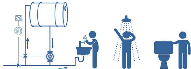
Fig. 2. Modelo Visual del Sistema que representa el abastecimiento de agua de baja altura de manera conceptual. Adaptado de [2]. Fuente: Elaboración propia.
