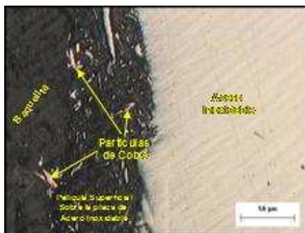
Figura 8. Sección transversal de la zona colocada en plantilla de cobre, con la cual, se realiza el proceso de de los elementos del intercambiador de calor de acero inoxidable 304.
