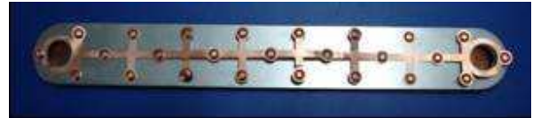
Figura 3. Rejilla de cobre sobre la que se realiza el proceso de soldadura de los paneles.
