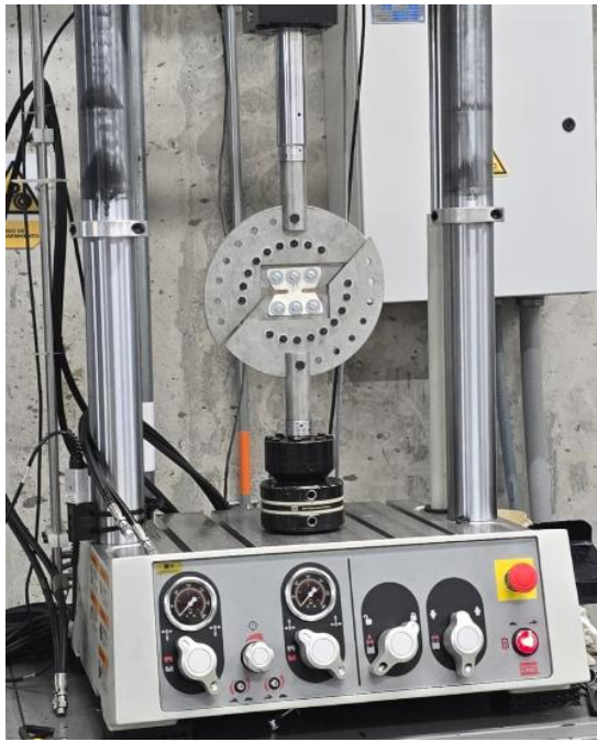
Figura 10. Montaje experimental de probetas tipo Arcan (Fuente: elaboración propia).
