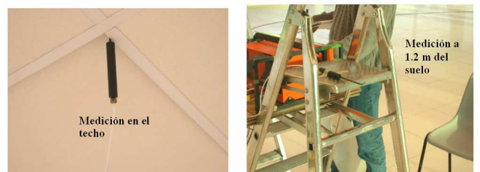
Figura 4. Detalles de la posición de los sensores.
