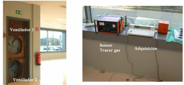
Figura 2. Detalles “blowing door” y sensor “Tracer gas”.
