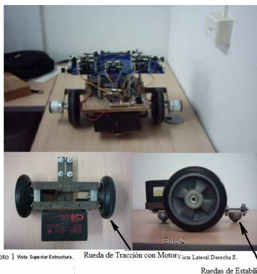
Figura 1. Plataforma móvil de tracción diferencial. Ruedas de Tracción con Motores y ruedas de estabilización.
