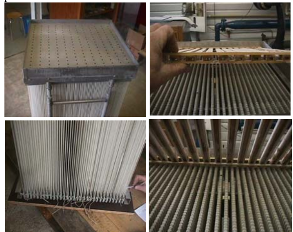
Figura 3. Detalles del humidificador adiabático tipo Amazon.
