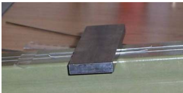
Figura 6. Montaje real para determinar los COFs para el contacto cerda-cerda
