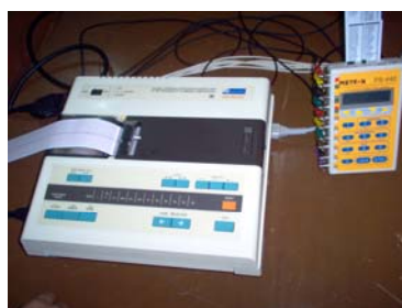
Figura 8. Conexión del simulador de paciente PS-440 y un ECG
