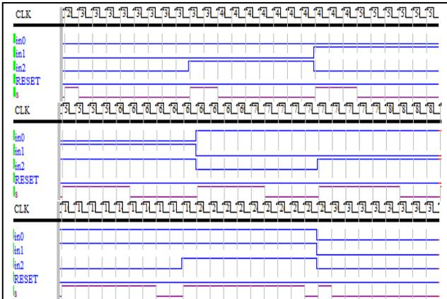
Figura 7. Resultados de la simulación de la FSM
