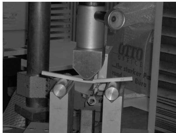
Figura 4. Ensayo de flexión de una probeta de Guadua.
