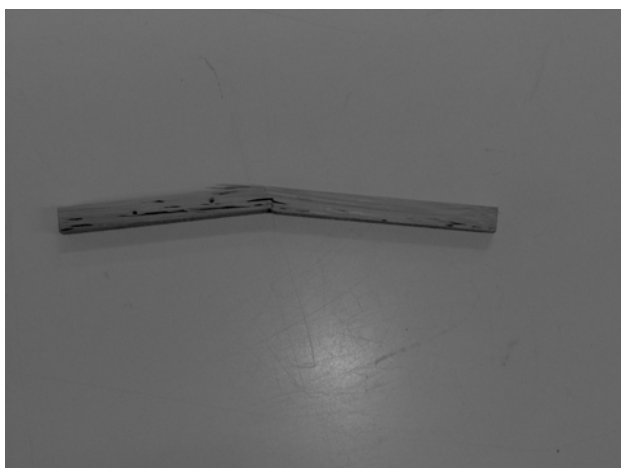
Figura 5. Probeta de ensayo a flexión rota.
