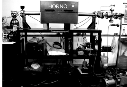
Figura 2. Equipo utilizado en la realización de los diferentes tratamientos térmicos e termoquímicos (nitruración).
