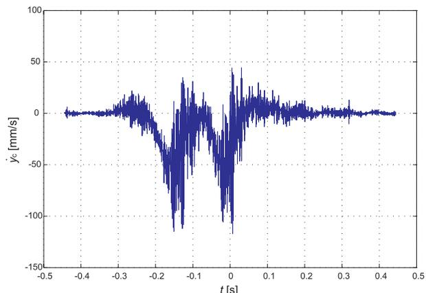
Figura 7.b. Velocidad de desplazamiento del carril al paso de un bogie obtenida por medio del modelo lineal para un perfil severo de irregularidad.
