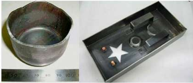
Figura 1. Embutido profundo en láminas de acero de grano ultrafino [17].
