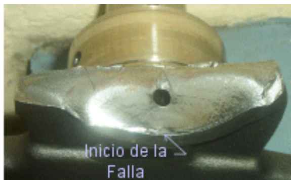
Figura 6. Superficie de fractura del pedazo desprendido del cigüeñal
