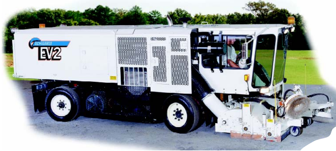
Figura 1. Barredora “seca” asistida por vacío. Schwarze Small-Micron Environmental Sweeper - Model EV2 (adaptada de [15])
