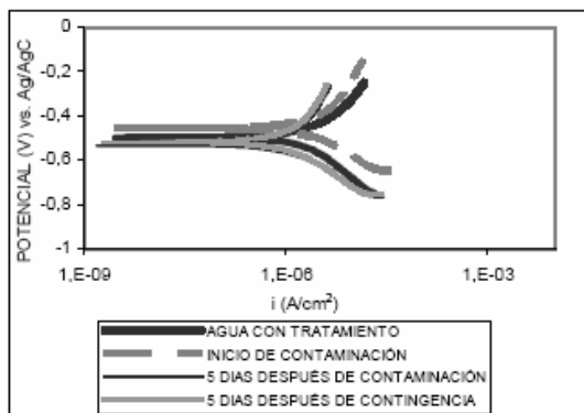
Figura 5. Curvas de polarización Tafel del acero 1020 en agua con inhibidor e hidrocarburo en el loop.
