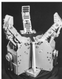
Figura 8. Gripper mecanico desarrollado por Laliberté (2002)
