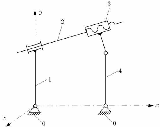
Fig. 9 Mecanismo de cuatro eslabones
