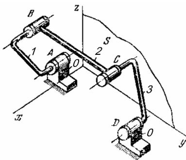
Figura 1. Mecanismo de cuatro eslabones [7].
