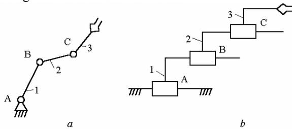
Fig. 3 a) Manipulador, b) Mecanismo de escalera telescópica
