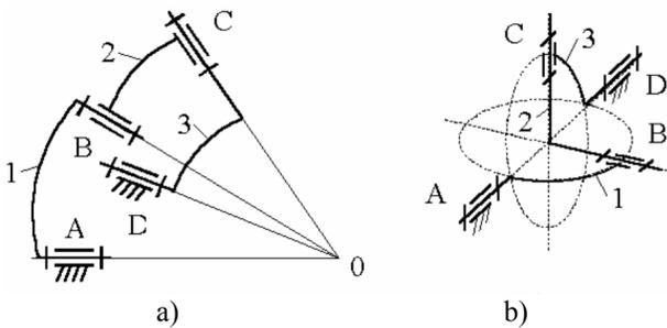
Fig. 7 Mecanismos existentes en superficies: a - Mecanismo esférico de cuatro eslabones; b - Junta de Hooke
