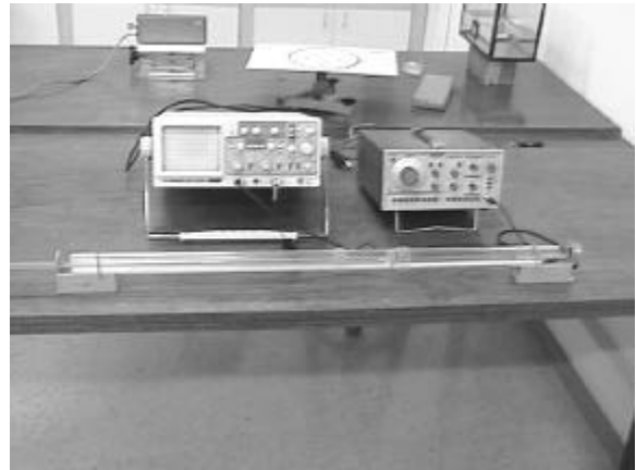
Figura No. 2 Elementos del proceso de medición de la absorción del sonido.
