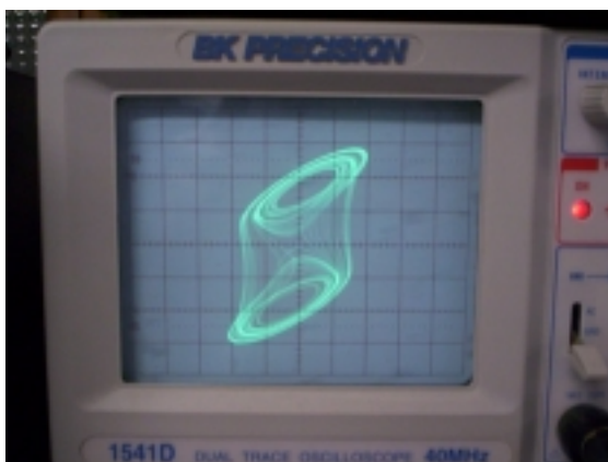
Figura 1. Oscilograma del circuito oscilador de Chua.
