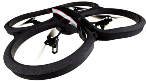
Figura 17. Cuadrimotor utilizado para la realización de las pruebas (Parrot Ar Drone)
