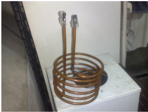
Figura 5. Serpentín de enfriamiento.
