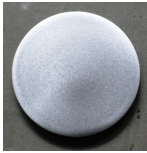
Figura 2. Probeta previamente lijada.
