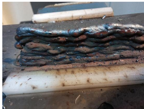
Fig. 2. Resultado de la aplicación inicial de once (11) capas sencillas.
